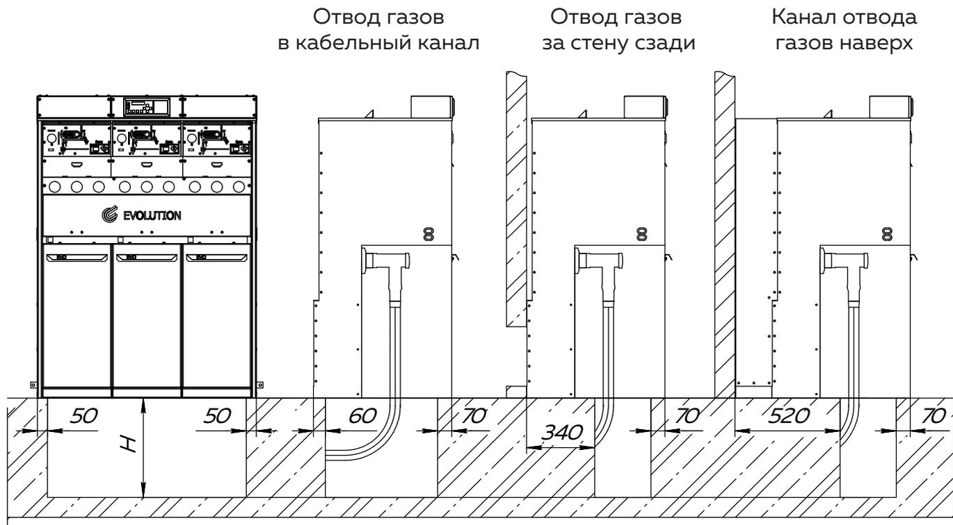
Подвод кабелей к распределительному устройству может осуществляться спереди, сзади, слева или справа. Если строительная часть выполнена без кабельных каналов, то следует применять КРУ EVOLUTION, укомплектованный цоколем.
